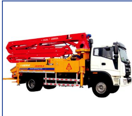
Xe bơm bê tông
